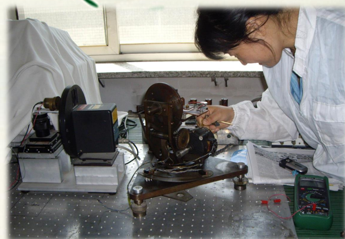
王守武设计研制的激光发散角分布测试仪
